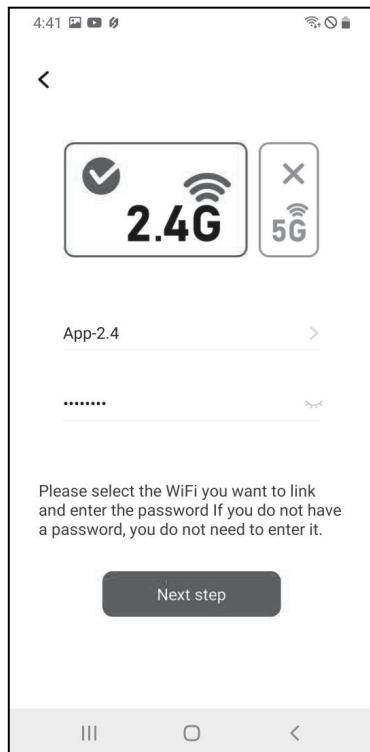
**3.3.4 本体の( )ボタンを長押して、Wi-Fi指示ライトが点滅してペアリング状態になり、[次のステップ]をクリックして続行します。**
